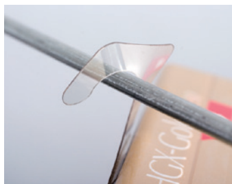
DEFLEXIÓN: El gancho se tuerce y empieza a fallar debido a demasiado peso.
